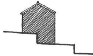
Terrain en terrasses : S'ancrer sur les murets de soutènement
